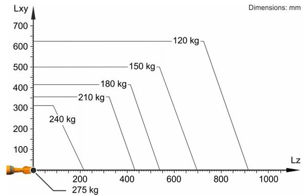
KR 210 R2700-2 设计用于 210 kg 的额定负载能力, 以便最佳利用机器人的性能和动态性。仅在质量重心位置为 0 mm 且安装了针对负载规格优化过的附加负载时, 275 kg 的最大负载能力才适用。必须用 KUKA.Load 或 KUKA Compose 检查特殊的负载情况。如果需要详细咨询, 请联系 KUKA 支持部。
